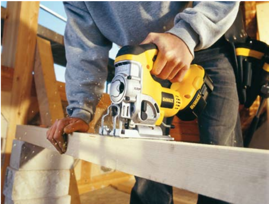
Grubość materiału może być w znacznym zakresie dowolna, gdyż zależy głównie od długości brzeszczotu. Im większa moc silnika, tym cięcie odbywa się szybciej.
